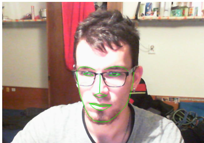
Obr. 17: Ukážka detekcie modelu so 68 bodmi v reálnom čase pomocou knižnice Dlib.
