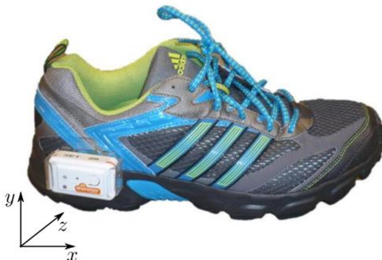
Obr. 16: Umiestnenie snímačej jednotky a definícia osí.
