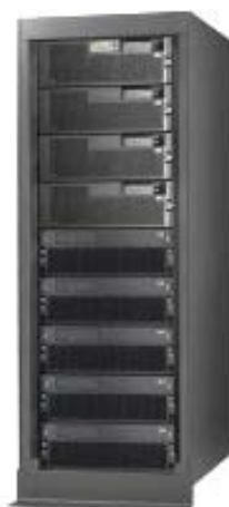
Obr. 8: IBM System i5 520 - kapacita operačnej pamäte do 32GB, priestor na pevných diskoch do 39TB
