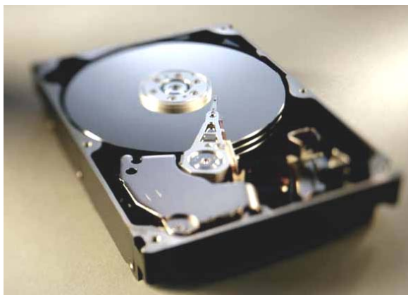
Obr. 28: Pohľad na pevný disk bez krytu a detailný pohľad na systém kotúčov a ramien so snímacími hlavami
