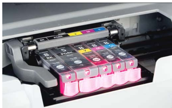
Obr.49: Uloženie zásobníkov s atramentmi v tlačiarni
