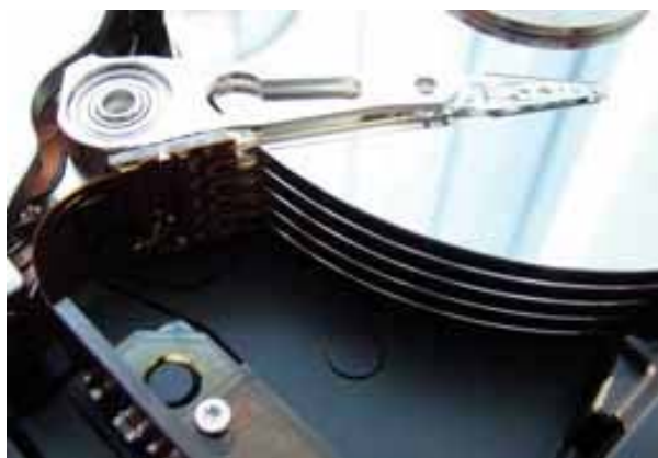
Obr. 28: Pohľad na pevný disk bez krytu a detailný pohľad na systém kotúčov a ramien so snímacími hlavami
